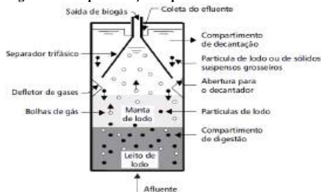
Figura 67 – Representação esquemática do reator UASB
