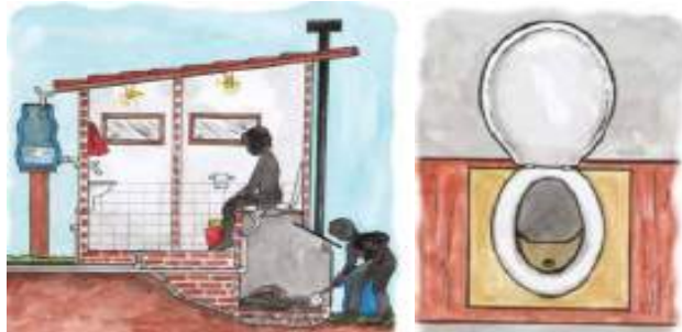
Figura 86 – Banheiro seco com bacia sanitária segregadora de urina
