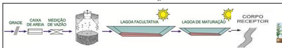
Figura 68 – Fluxograma típico de um sistema de tratamento com reatores UASB seguidos por sistema de lagoas
